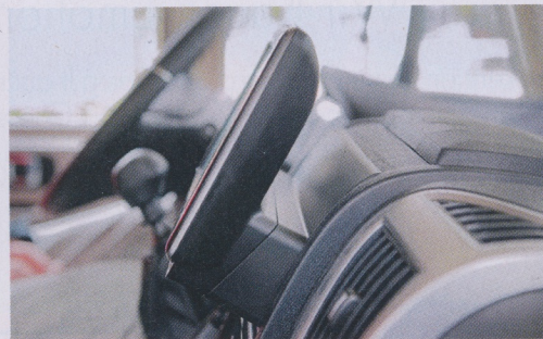
Etwa elf Zentimeter ragt das D901 D-DU aus dem Einbauschacht heraus. Der Sockel besitzt kein Gelenk.
