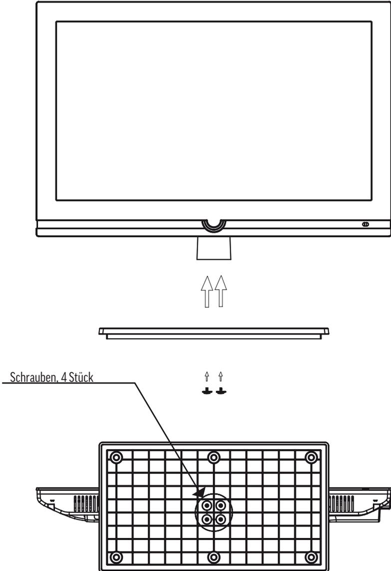
T-Linie: Befestigung wie bei der R-Linie (4 Schrauben)
