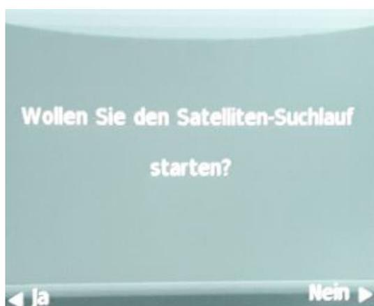
Dann beginnt der „Suchlauf“. Allerdings wird hier die Programmliste vom USB-Stick in den Tunerspeicher integriert. Nach dem Suchlauf erscheint das erste Programm der Liste wenn die Antenne auf Astra 19.2° eingestellt ist.
