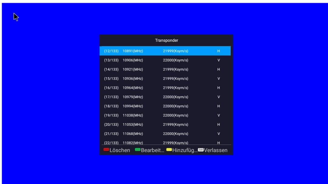
4. In dem Auswahlfenster kann nun die Frequenz, Symbol sowie Polarität manuell eingegeben werden. Diese haben wir Ihnen auf der Homepage zur Verfügung gestellt. Nach der Eingabe sichern Sie diese bitte mit der „Enter“-Taste.
